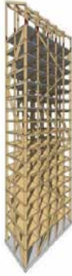
Şekil 7. Lamine ahşap taşıyıcı iskelete sahip Mjos Tower, Norveç
